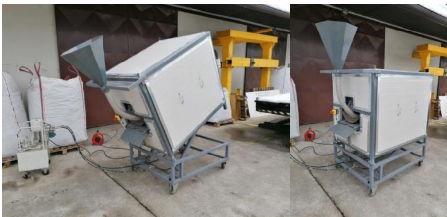
Slika 1. Naprava za termično obdelavo zrnja soje, opremljena z rotacijskim bobnom za seme soje (bobnu se lahko brezstopenjsko spreminja število vrtljajev glede zahtev pri termični obdelavi), za termično obdelavo semena soje so namenjeni IR grelci nameščeni radialno po obodu bobna, za praznjenje bobna se uporablja hidravlika (na levi sliki je naprava v poziciji pri praznjenju), celotna naprava je izolirana s pomočjo izolacijskih sendvič plošč iz mineralne (kamnite) volne, s tem se značilno zmanjšajo toplotne izgube (vir: Kmetijski inštitut Slovenije, Oddelek za kmetijsko tehniko in energetiko)
