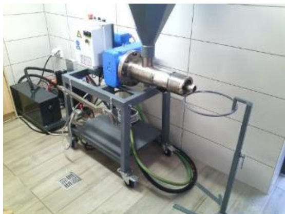
Slika 5: Vijačna stiskalnica AIS P 95, moči 4 kW omogoča večji delovni učinek pri stiskanju soje, primer mikro oljarne na kmetiji (Fotografija: V. Jejčič)
