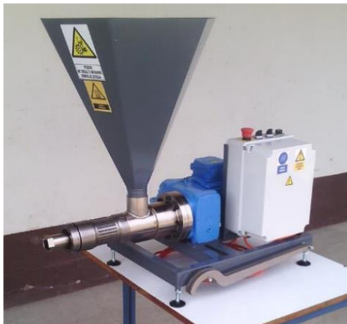
Slika 1: Vijačna stiskalnica AIS P 60 omogoča stiskanje soje (Fotografija: V. Jejčič)
