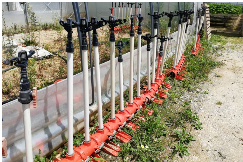
Slika 6: Namakalna oprema: razpršilci.
