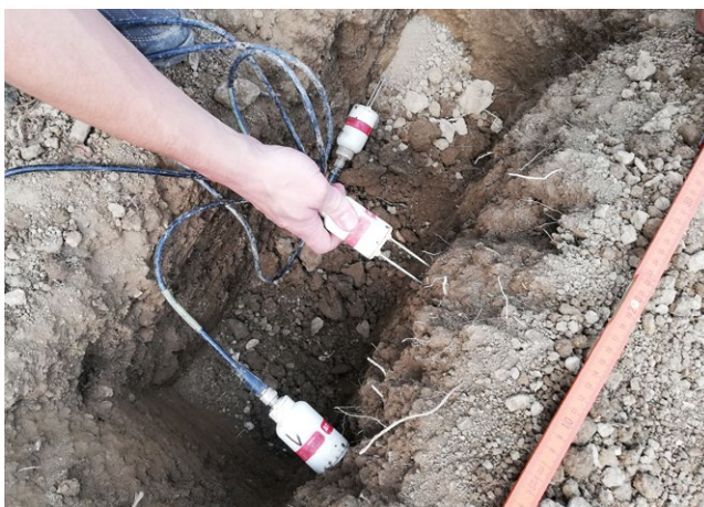
Slika 25: Vgradnja merilnikov vsebnosti vode v tleh.
