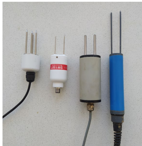
Slika 26: Različni merilniki vsebnosti vode v tleh.
