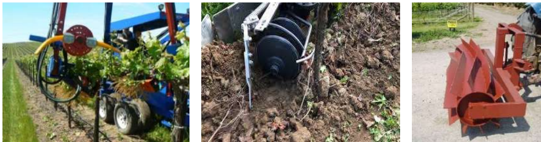
Slike 7-9. Stroji za pletev (levo), upravljanje tal pod trtami (sredina) in v medvrstnem prostoru (valjar, desno) (foto: Winebusiness, Butlerent, Orticoltura Bio).
