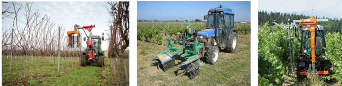
Slike 4-6. Stroji za zimsko rez (levo), mandanje (sredina) in vršičkanje (desno) (foto: Apps M., FA.MA, Rinieri).
