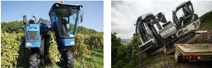
Sliki 15, 16. Stroja za trgatav v ravninskih vinogradih (levo) in za trgatav na vertikalnih ali terasah (desno) (foto: Wag magazin, Wein.plus).
