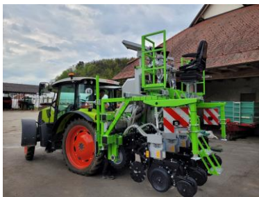
Sejalnica za presledno setev poljščin za namene izvedbe natančnih mikroposkusov
