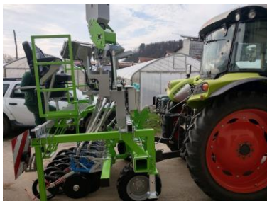
Sejalnica za strnjeno setev poljščin in trav za namene izvedbe natančnih mikroposkusov
