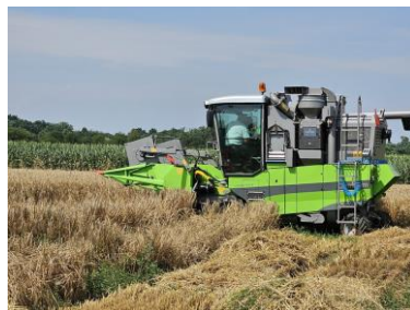
Kombajn Wintersteiger Quantum, za žetev in vrednotenje mikroposkusov in osnovno analizo vzorcev
