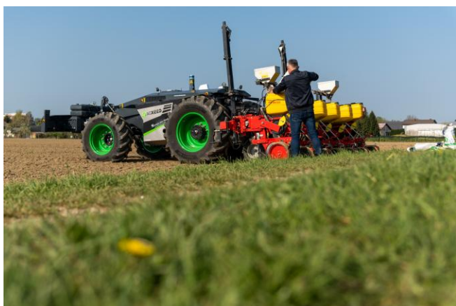
Priprava in nastavitev sejalnice pred začetkom avtonomne naloge. Foto: Jan Vitez, 2026.
