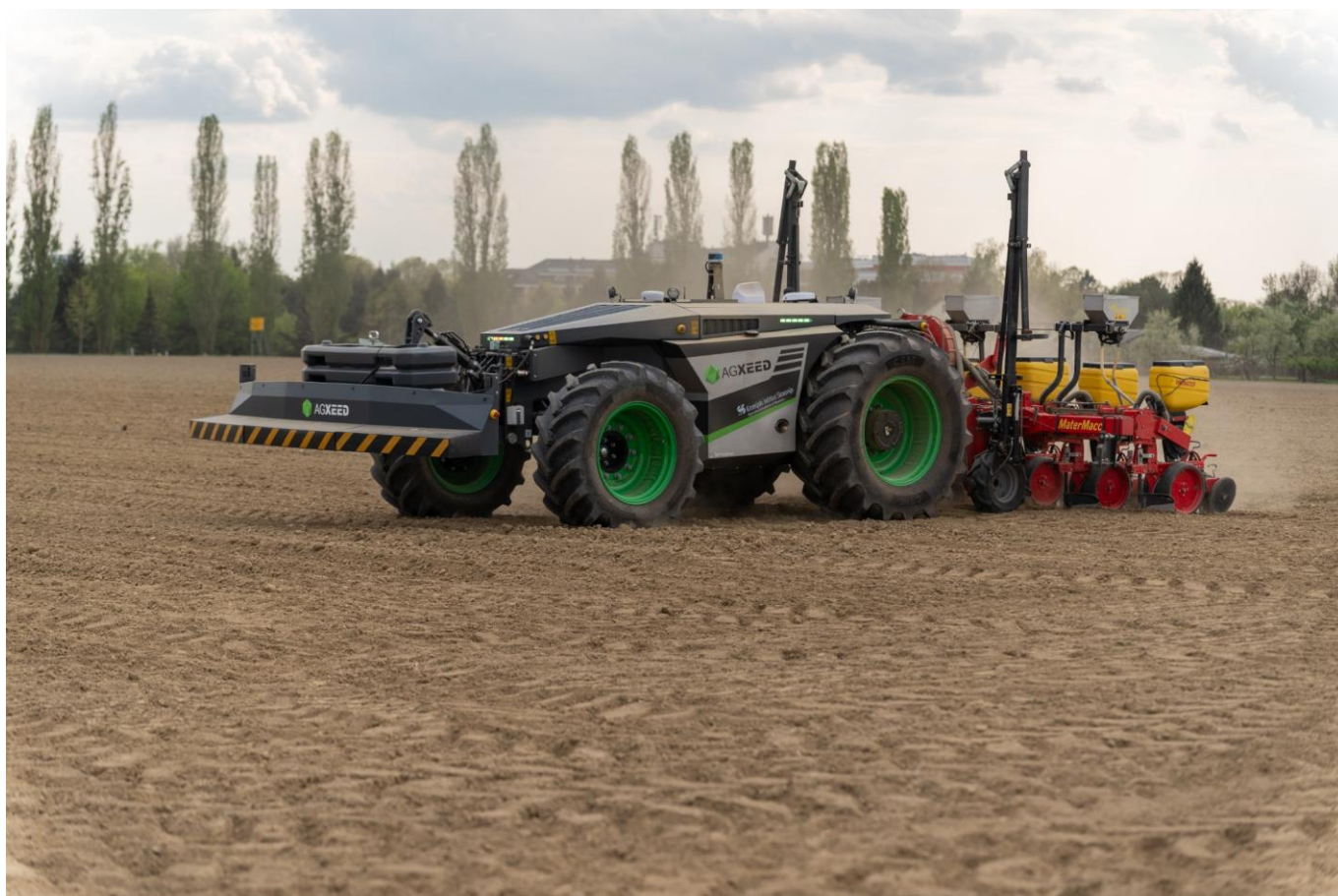
AgXeed AgBot 2.055 W4 s šestvrstno sejalnico MaterMacc med setvijo koruze na kmetiji Vitez. Foto: Jan Vitez, 2026.
