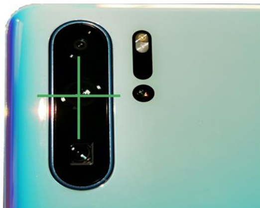
Slika 2: Zelen križec usmerimo točno v sredino odseva leče kamere
