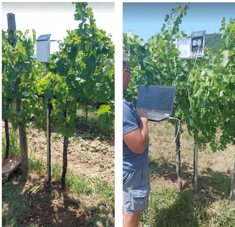
Slika 12 Avtomatski pomnilnik ZL6, nameščen v tla z ozelenjenem medvrstnim prostorom (Zupanc, 2021)
