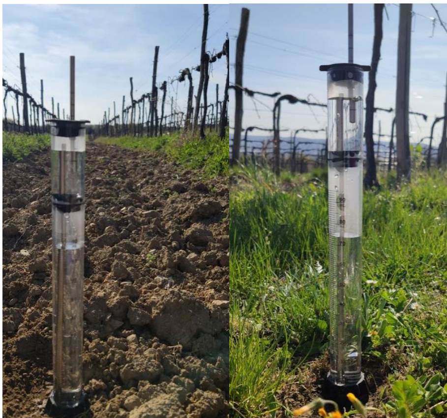
Slika 18: Merjenje infiltracije na medvrstnem prostoru brez rastlinskega pokrova in ozelenjenem medvrstnem prostoru
