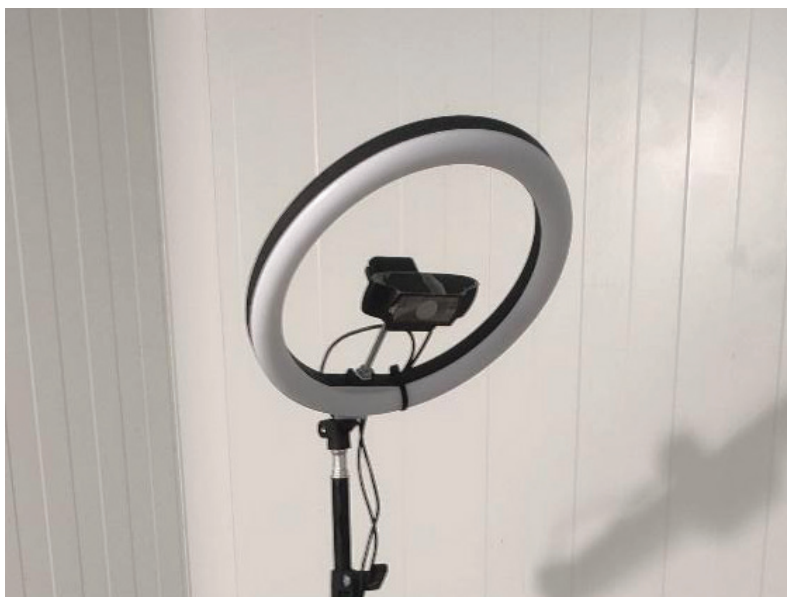
Slika 8: Optični senzor in sistem osvetlitve nameščen v notranjosti komore
